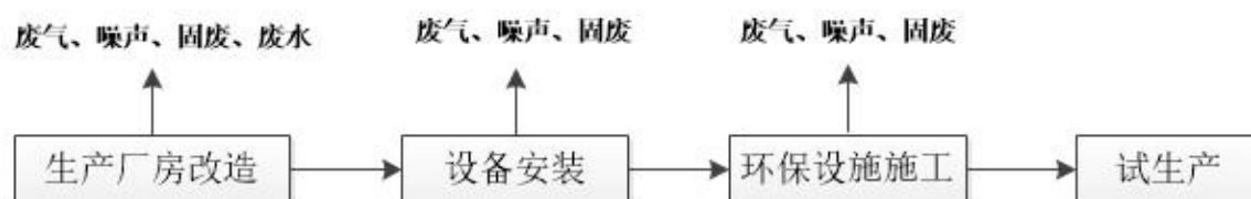
图 3.2-1 项目施工期工艺流程及产污节点图
