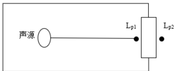
图 4.3-1 室内声源等效为室外声源图例
