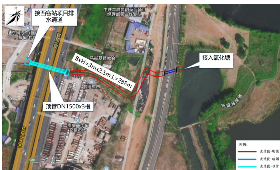
图 2-30 干沟尾（碧鸡路-氧化塘）排洪渠平面布置图
