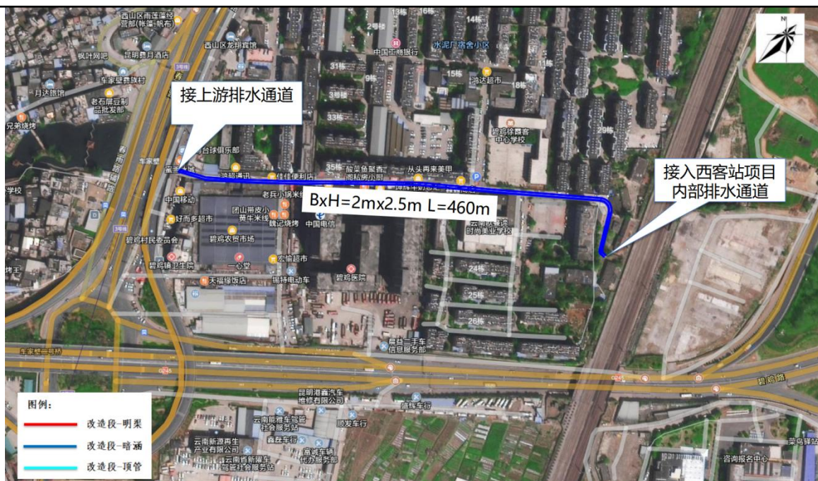
图 2-26 车家壁沟（碧鸡农贸市场段）排洪渠平面布置图
