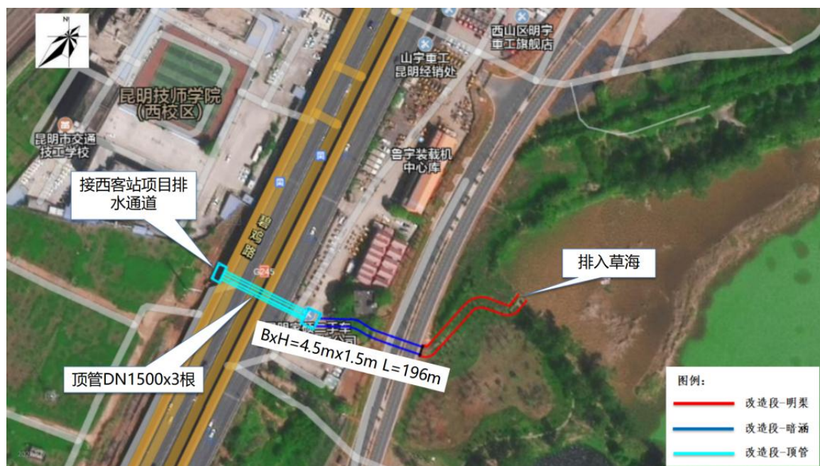
图 2-31 3 号车辆 2#沟排洪渠平面布置图
