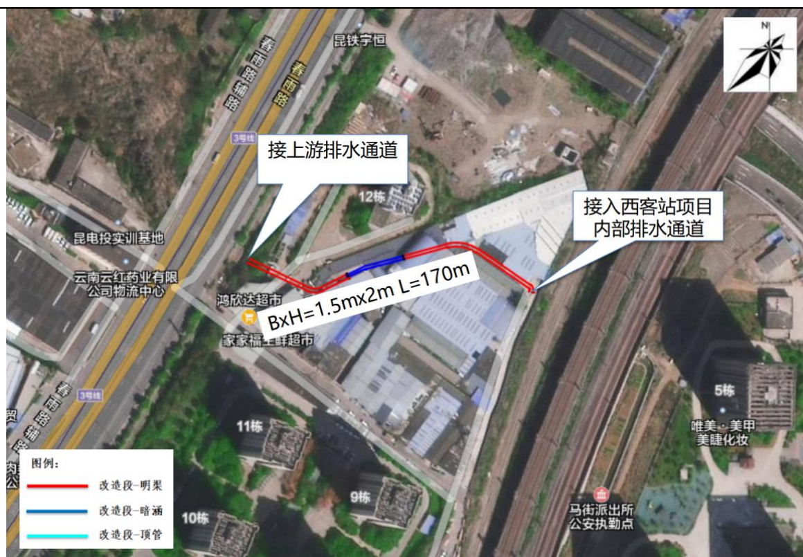
图 2-32 渔村沟 2#支沟排洪渠平面布置图
