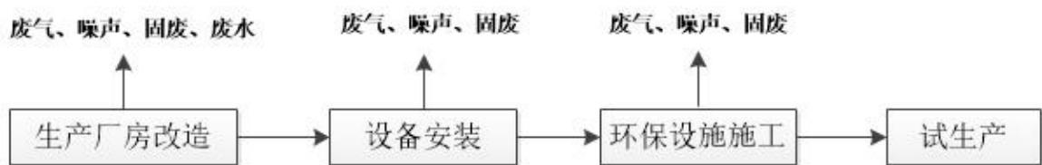
图 3.2-1 项目磷石膏改性装置生产区施工期工艺流程及产污节点图
