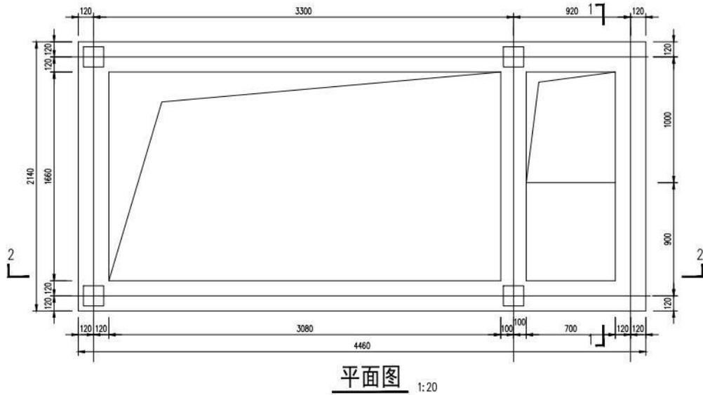
图 2-8 电缆分接箱基础体型图
