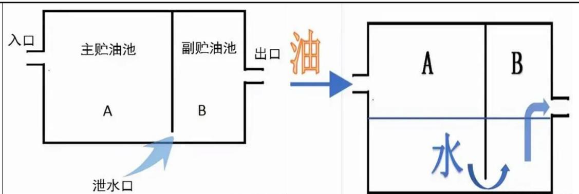
**主变事故情况下废油收集流程：**即在主变地基基础上铺设一定厚度的卵石层，卵石层下设置集油井，集油井储油量达到限值，变压器油会经地沟流至事故油池，事故油池主要防止变压器油外泄而污染环境。在日常运转检修以及事故状态下，废变压器油会经底部卵石层和集油井汇集后，通过管道流入事故油池。下雨时，雨水也会经过底部集油坑汇集流入事故集油坑。事故油池具备简单的油水分离功能，主要利用油的容重比水的容重小且油水不相溶原理，实现油水分离。主变基础卵石层及集油井内卵石层的作用为：1、防火：卵石层起到隔离作用，减小火势，利于灭火；另外高温变压器油经过鹅卵石的冷却后，可减小火势。当变压器油着火时，燃油漏到油池后，将其火源与变压器本体隔离。避免火灾事故的扩大。2、泄油：防止杂物堵塞泄油坑底部的排油（水）孔。3、检修：可以根据鹅卵石上面的油渍判断主变渗漏油情况，便于检修。
