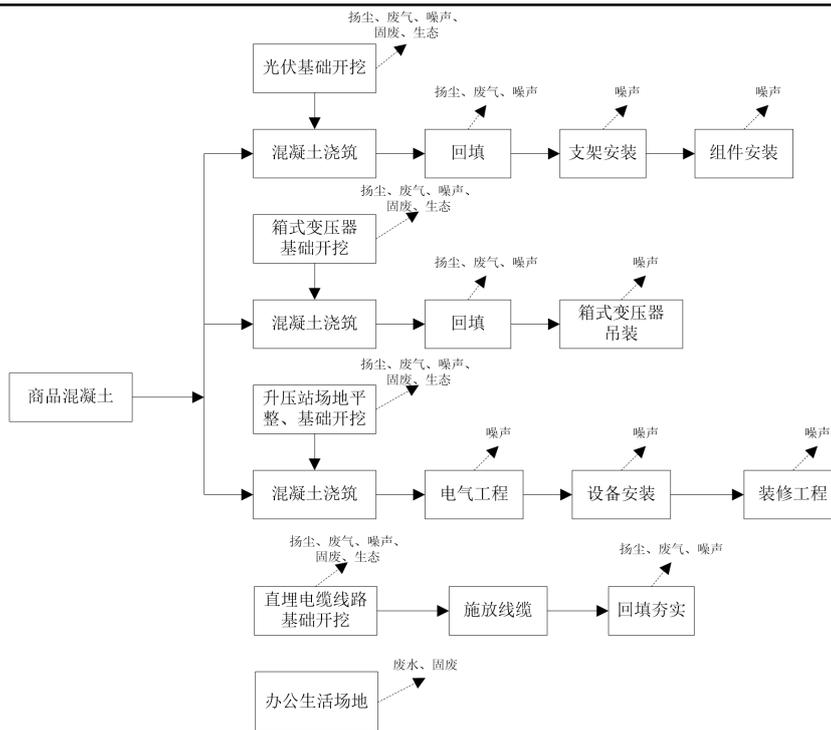
图 2-9 施工期工艺流程及产污节点
