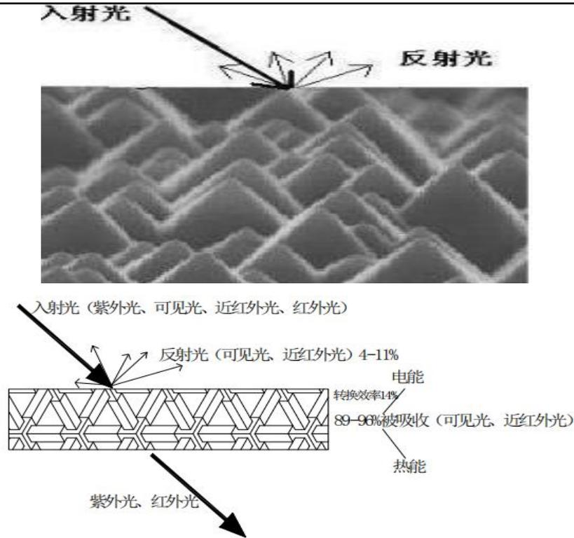
图 4-7 太阳能电池反射示意图
