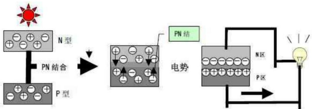
图 4-1 太阳能光伏发电原理
