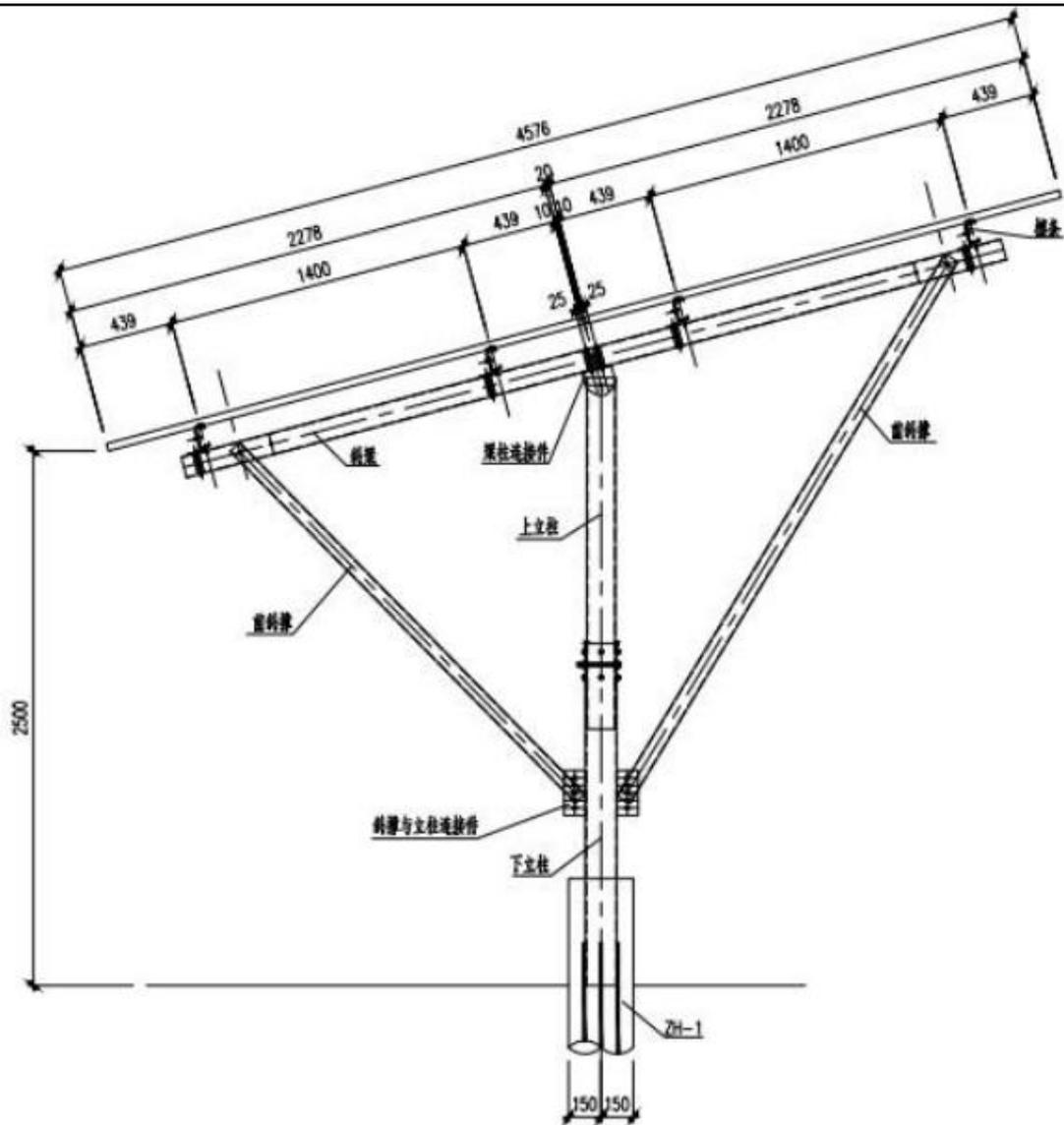
图 2-5 固定式光伏组件支架典型设计图
