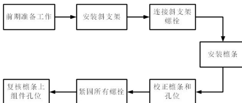
图 2-8 太阳能电池组件支架安装工艺
