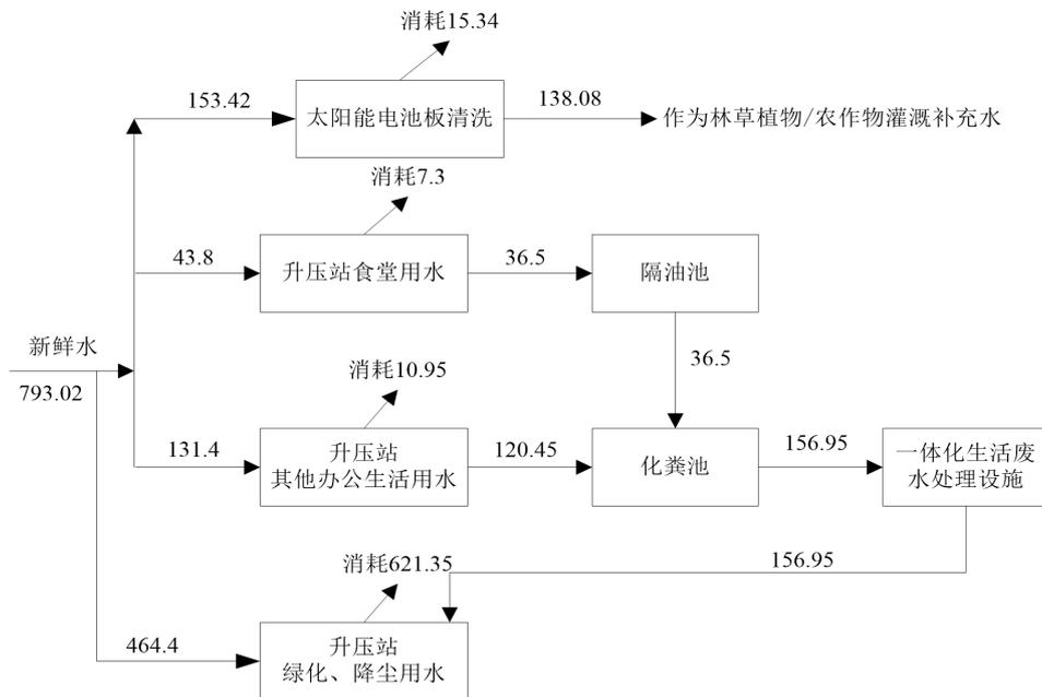
图4-4 项目运营期间水量平衡图 单位：m<sup>3</sup>/a
