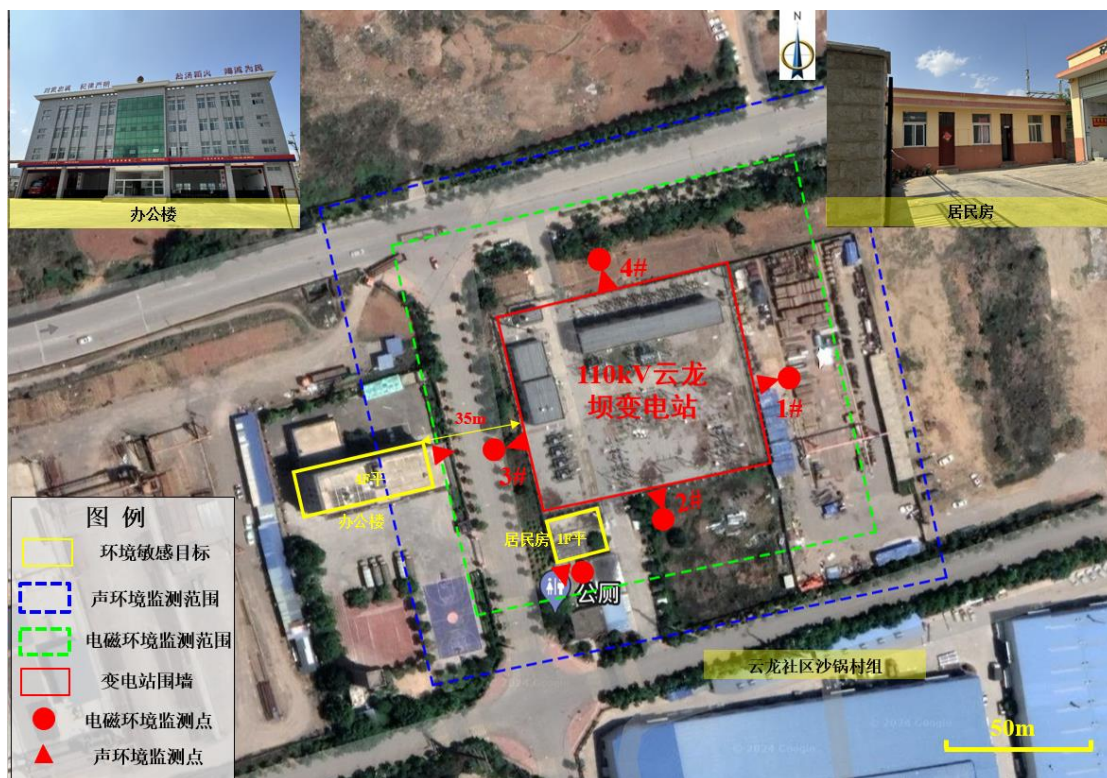
图 26 110kV 云龙坝变电站监测点位示意图
