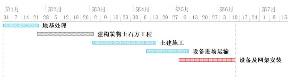
图 8 变电站扩建工程施工时序图
