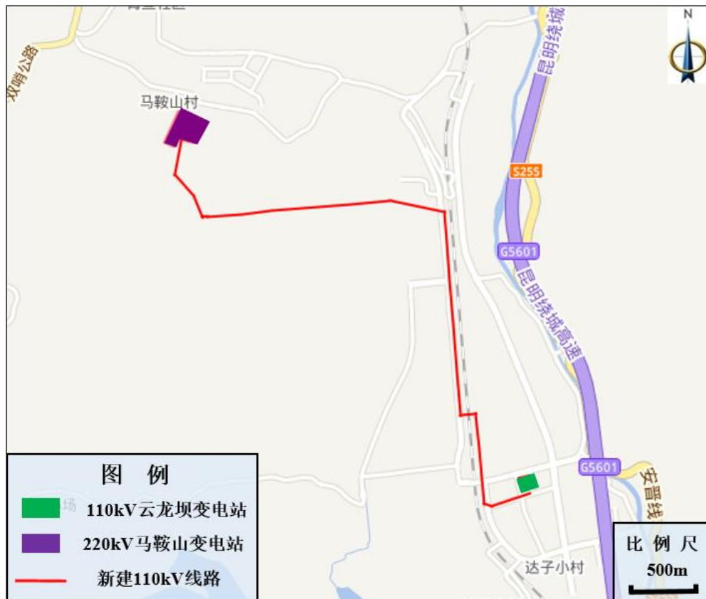
图1 本工程 110kV 线路路径示意图
