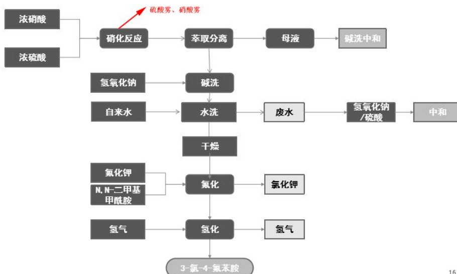
图 2-10 3-氯-4-氟硝基苯工艺流程
