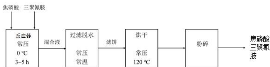
图 2-6 焦磷酸三聚氰胺合成实验流程图
