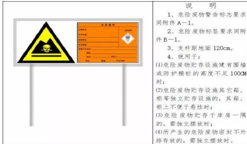
图 4-5 室内外悬挂的危险废物标签
